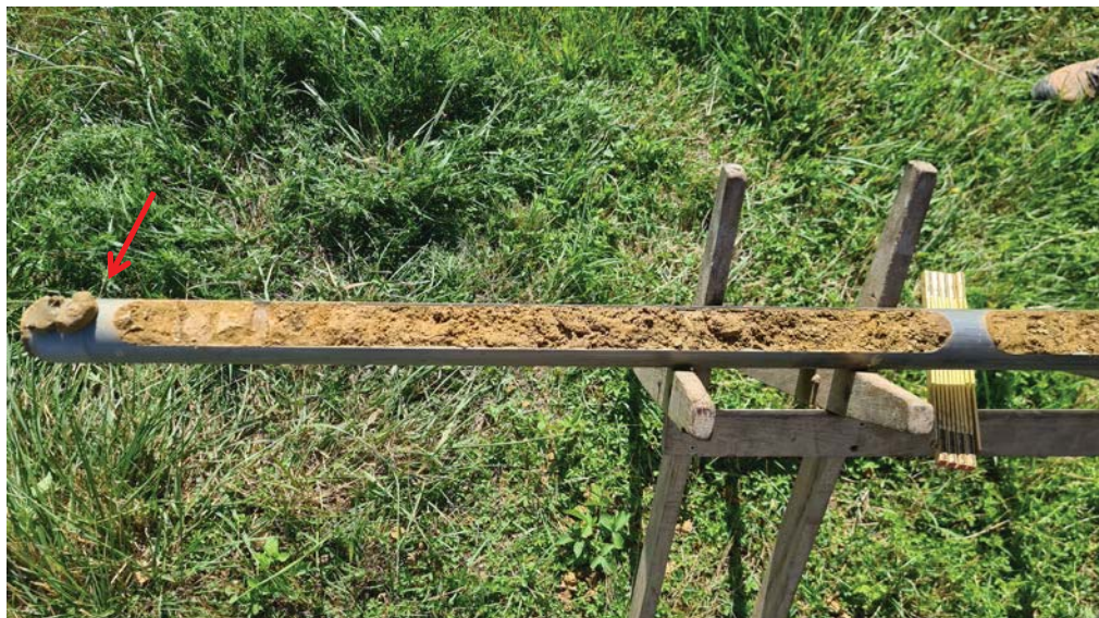
Bild 3 + 4: Schurf 4 – bis zu einer Tiefe von 3,5 m bestehen die Deckschichten aus Lößlehm. An der Sohle des Schurfs wurde der Übergang zum unterlagernden Kies angeschnitten.
