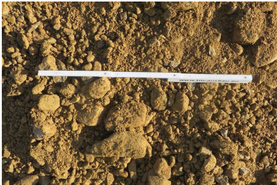
Bild 1 + 2: Schurf 3 - unter einem ca. 0,3 m starken Oberbodenhorizont wurde bis zur Endtiefe von 2,60 m Kies mit relativ hohen Schluffanteilen angetroffen. Hinweise auf Grund- oder Schichtwasser waren nicht zu erkennen.
