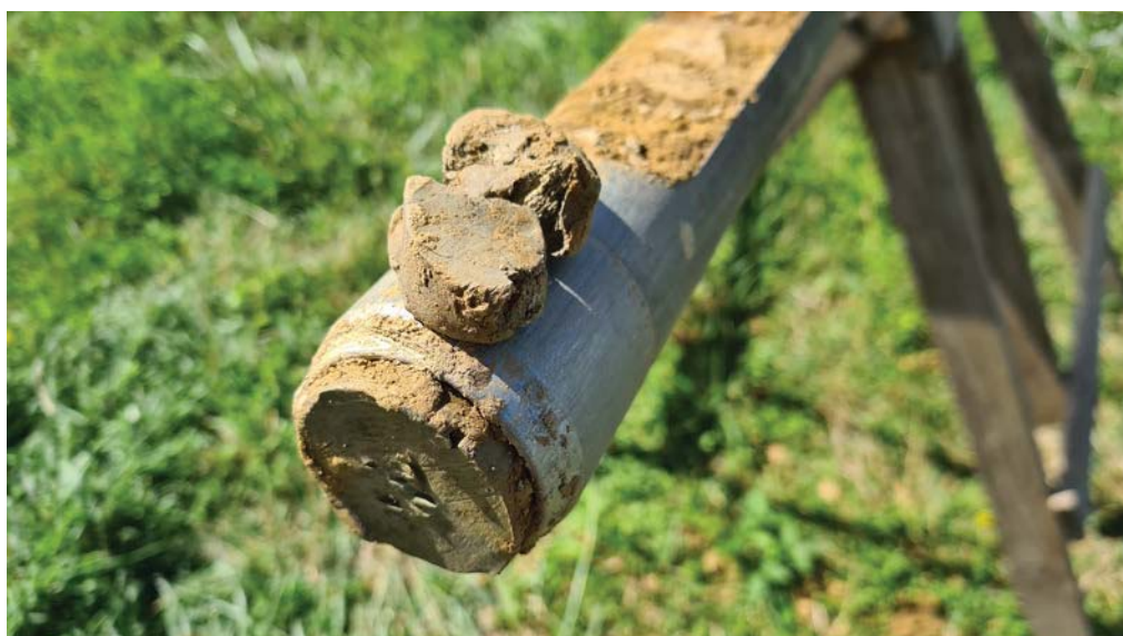
Bild 5 + 6: In der Rammkernbohrung RKS 1 ist in 4,9 m Tiefe ein Tonhorizont erreicht worden, bei dem es sich vermutlich um das so genannte 'Sulzbach-Tertiär' handelt. Der Kieshorizont darüber ist Grund- / Schichtwasserführend. Der Wasserspiegel lag zum Zeitpunkt der Bohrung bei 3,7 m Tiefe.
