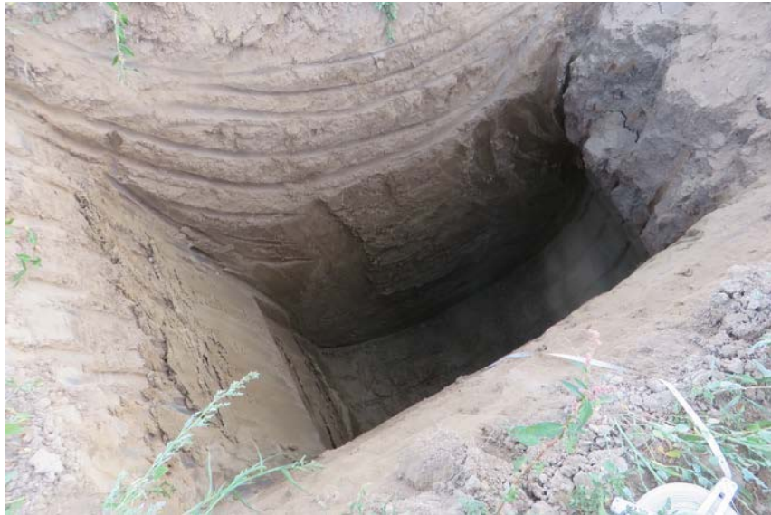
Bild 3 + 4: Schurf 4 – bis zu einer Tiefe von 3,5 m bestehen die Deckschichten aus Lößlehm. An der Sohle des Schurfs wurde der Übergang zum unterlagernden Kies angeschnitten.
